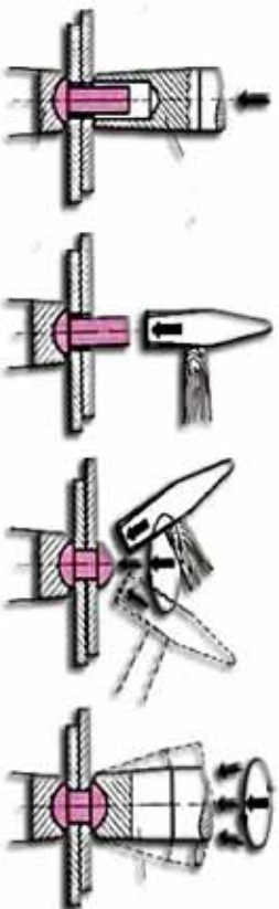
(۳-۱) شکل، د دوه ټوټي فلزاتو د پرچکارۍ مرحلي
