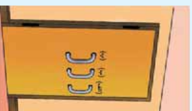
(5-5) شکل، هغه نقطه چې قوه په کې واردیږي، د قوې د مومنت په اندازه کې مهم رول لري
