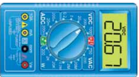
شکل (3-22)، دیجیټالي ملتي متر
