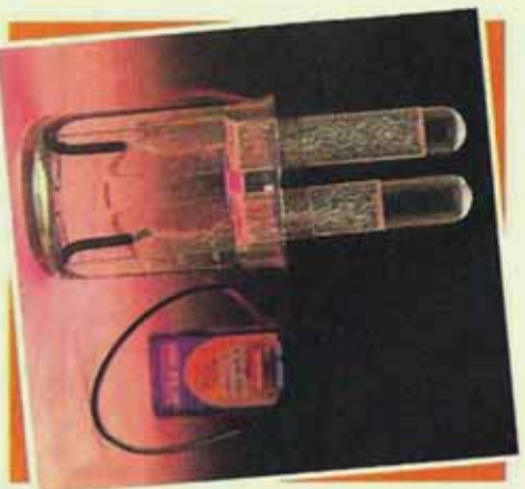
(10-4) شکل د اوبو بریښنايي تجزیه ښيي
