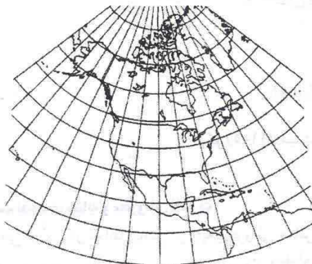
شکل (۵-۱۲) سیستم تصویر نقشه مشابه و مخروطی
