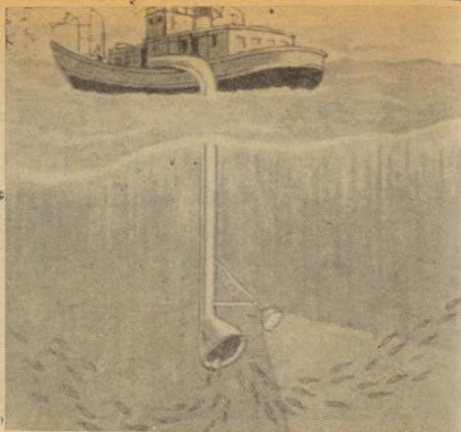
ماهی ها توسط چراغ جلب گردیده و توسط پمپ به سطح کشتی انتقال می یابند
