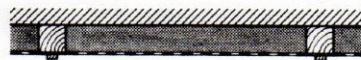
1 50mm ډبل د زیلان لاندېستونی د کلک دېوال مخ ته بی د پوینښ یا د نري 20% سوري تختو سره
