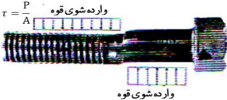
15.3- شکل: دویجاړ شوي بولټ بېلگه د تشنجاتوله اغېزې
