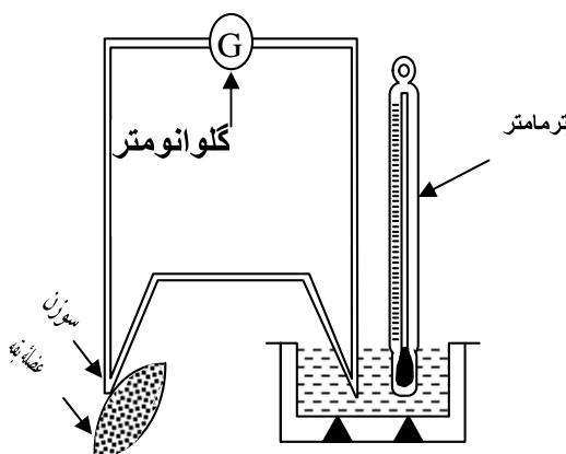
شکل (6-2) ترمومتر الکتریکی
