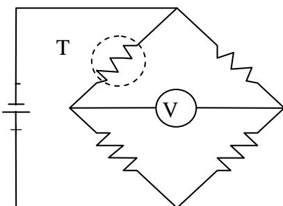
شکل 3-2 شیمای ترمیستور
