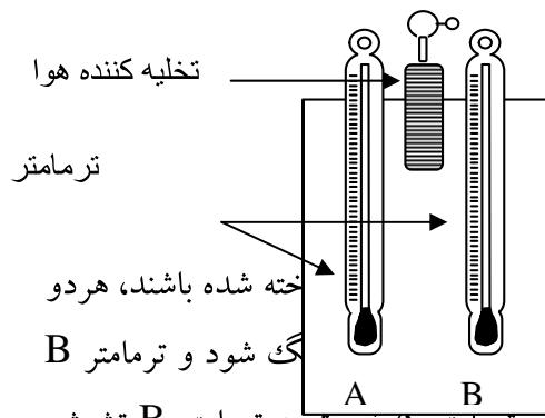
هرگاه ترمومترها دارای ابعاد مساوی باشند، هر دو شکل (3-4) شبیه جذب تشعشع به یک اندازه حرارت اخذ میکنند. اگر توسط نقره ملمع گردد، در اینصورت ترمومتر A نسبت به ترمومتر B تشعشع بیشتر جذب کرده و در نتیجه حرارت آن به سرعت بلند میرود. ترمومتر سیاه شده ۹۷ فیصد تشعشع وارد را جذب میکند، در حالیکه ترمومتر B تقریباً ۱۰ فیصد را جذب مینماید، هرگاه هر دو ترمومتر همزمان از فلاسک خارج و بداخل یخچال گردد، درجه حرارت ترمومتر A نسبت به ترمومتر B به سرعت
