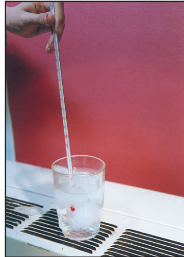
(۱-۲۹) شکل: د یخ دویلي کبډوټکي اندازه کول
