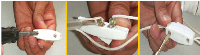
شکل (۲-۲۴): د سیار څراغ د سیم په امتداد کې د سوپچ د نصبولو مرحلې
