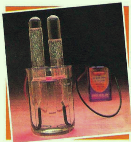
(10-4) شکل د اوبو برېښنايي تجزیه ښيي
