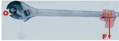
شکل 1-30 د پیچ ټینګول د رنج په وسیله
