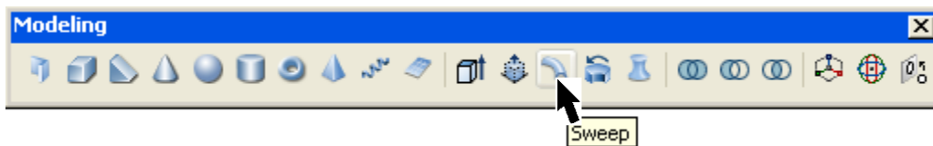
شکل د (Modeling) منیو څخه د کشولو (Sweep) د هد ایت غوره کول
