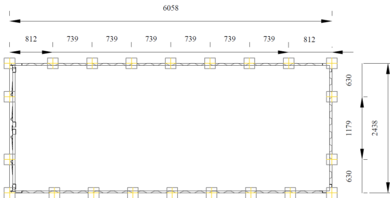
پلان بلوک کانکریتی ۲۰۰ در ۲۰۰ در ۲۰۰ ملی متر برای کانتینر ۲۰ فوت، مارک ۱:۳
