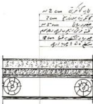
دیتایل قسمت پوشش (بام) تعمیرات محلی چوب پوش
