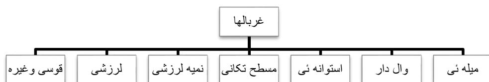
سطح کاری غربال های مسطح تکانی حرکت اجباری را به اندازه معین و دقیق رفت و برگشت و مسیرها انجام داده که ارتباط سخت سینماتیکی بین محرکه و میکانیزم که در آن شبکه نصب میگردد برقرار میسازد. اندازه رفت و برگشت و مسیر حرکت این میکانیزم مربوط به سرعت دوران وال محرکه دار و بارگیری غربال نمیباشد.
