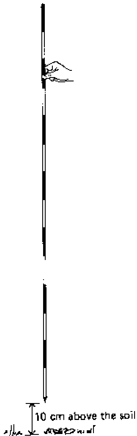
۱۰ شکل درینجینگ پول نیول Fig. 10 Holding a ranging pole
