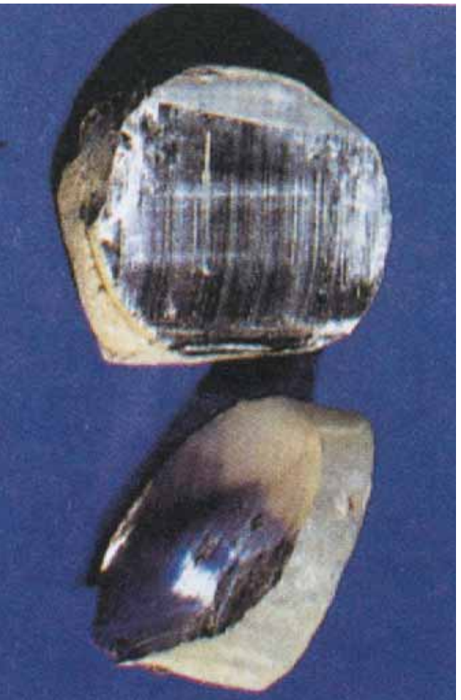
(۳-۹) شکل د سوديټم زنگ وهل د اکسيجن په واسطه
