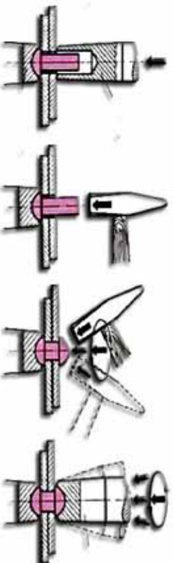
(۳-۱) شکل، د دوه ټوټي فلزاتو د پرچکاری مرحلي
