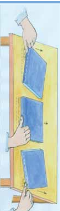
(1-5) شکل، د قوي اثر له هغې نقطې سره چي قوه پرې واړه شوېده، اړیکې لري.
