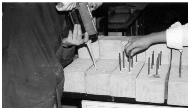
۴- شکل (د تماس سطحي لپاره فولادي سیخانو نصب
