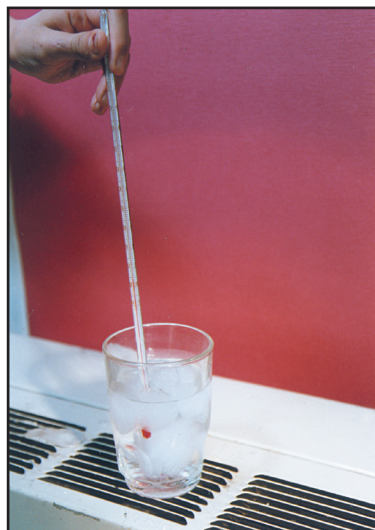
(۱-۲۹) شکل: د یخ دویلي کبډوټکي اندازه کول
