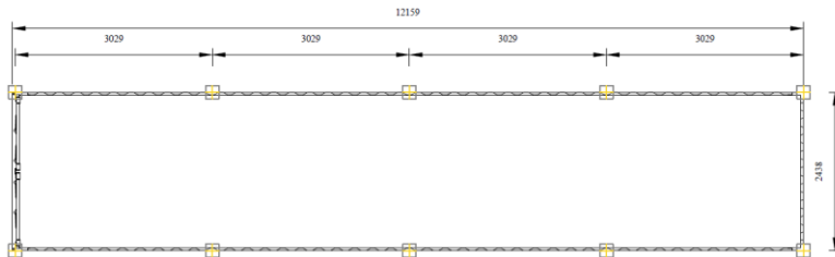
پلان بلوک کانکریتی ۲۰۰ در ۲۰۰ در ۲۰۰ ملی متر برای کانتینر ۴۰ فوت، مارک ۱:۳
