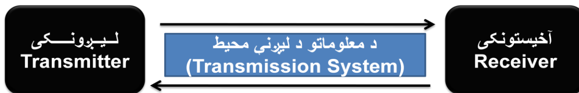
[۱.۱] شکل، د مخابراتي سيستمونو ډياگرام.
